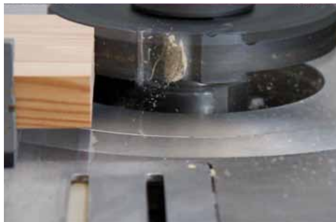
Chip flow system: designed to optimize the chips discharge. Sistema di scarico del truciolo: ottimizza l'evacuazione del truciolo.
